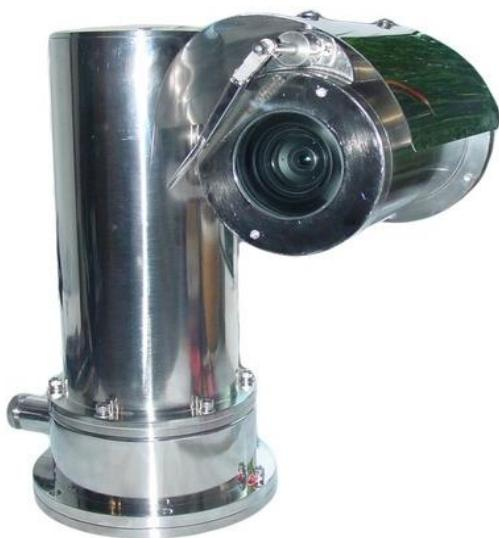
Взрывозащищённая поворотная камера с дворником и козырьком TKNPTZ-4-HD-IP (далее - камера) предназначена для видеонаблюдения в пожаро- и взрывоопасных местах, и помещениях, при контакте с окружающей средой без дополнительной защиты. Камера обеспечивает обзор 360° в горизонтальной и вертикальной плоскостях благодаря поворотно-наклонному (PTZ) механизму, а также изменению настроек объектива IP видеокамеры, выполненной на базе матрицы 1/2,8" Sony Exmore CMOS с оптическим увеличением 20X или 30X.
