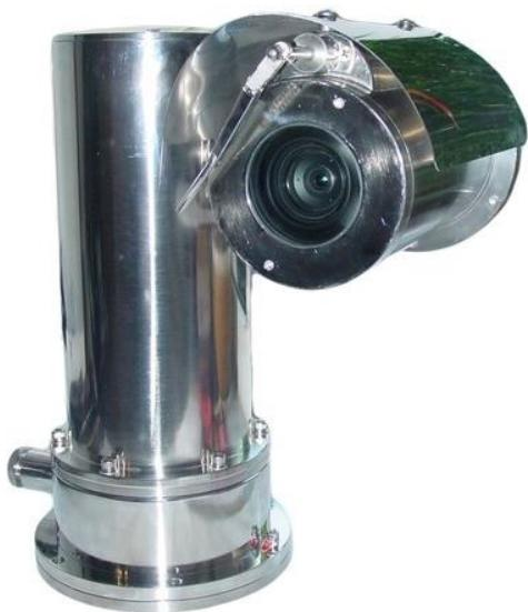
Взрывозащищённая поворотная камера с дворником и козырьком серии ТКНПТZ (далее - камера) предназначена для видеонаблюдения в пожаро- и взрывоопасных местах, и помещениях. Камера обеспечивает обзор 360° в горизонтальной плоскости и +/-90° в вертикальной благодаря поворотно-наклонному (PTZ) механизму, а также изменению настроек аналоговой видеокамеры, выполненной на базе матрицы 1/4 Sony EX-View HAD CCD с оптическим увеличением в 36X и цифровым увеличением 12X.
